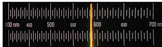
Betrachten Sie folgenden Versuchsaufbau: Licht von einer Quelle trifft auf Natriumdampf. Zum einen wird das Spektrum des durchgehenden Lichts gemessen, zum anderen das Spektrum von seitlich emittiertem Licht.
